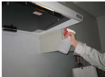
▲レンジフードにトレーサガスを噴霧
