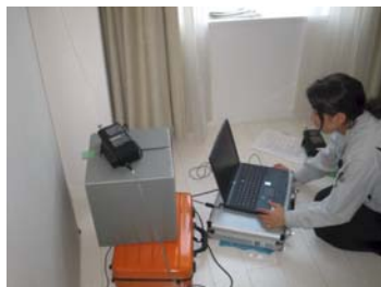
▲PCで臭気浸入状況を監視
